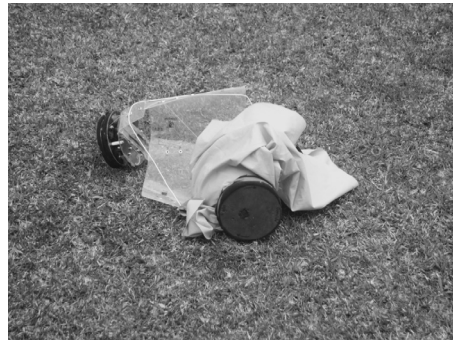
図5 走行開始する際、パラシュートに絡まってしまった CanSat (左) 2011年度
