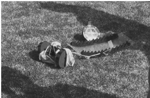
図5 走行開始する際、パラシュートに絡まってしまった CanSat (左) 2011年度
