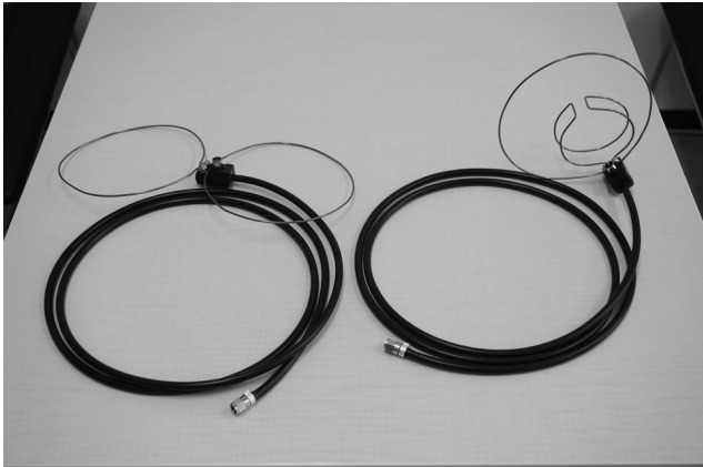
図2 地デジTV放送受信アンテナの自作例
