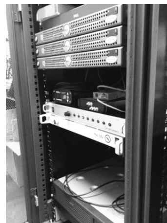
図5 マルチ GNSS シミュレータ装置(写真中央)
