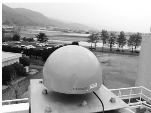
図6 チョークリング付きマルチ GNSS アンテナ
