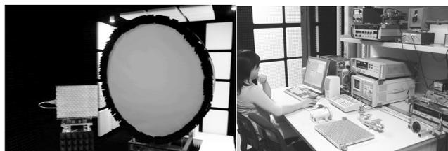
図 1 アンテナの放射パターン測定風景
