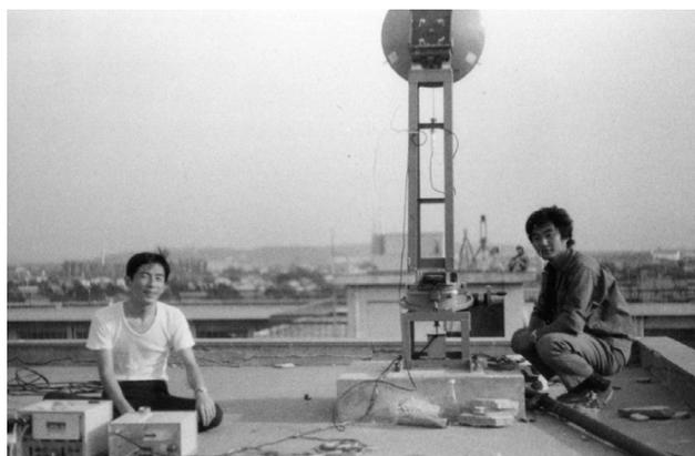
図 2 アンテナ放射特性実験風景
